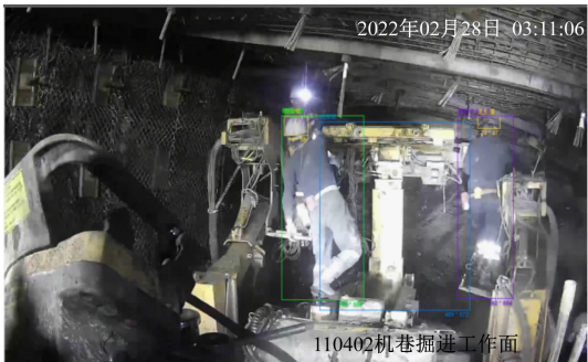
图 4 临时支护前探梁识别效果
