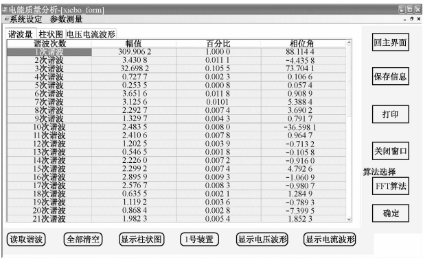
图 10 上位机显示的谐波数据结果
