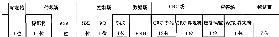
图5 CAN报文数据帧结构
