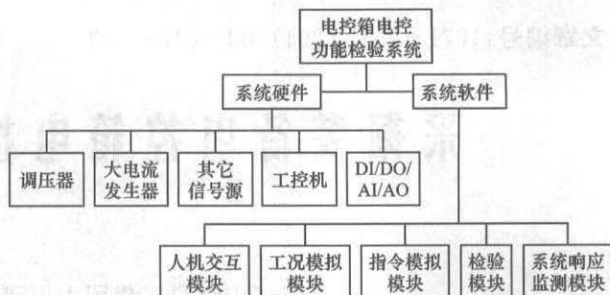
图2 采掘装备电控箱电控功能检验系统硬件组成
