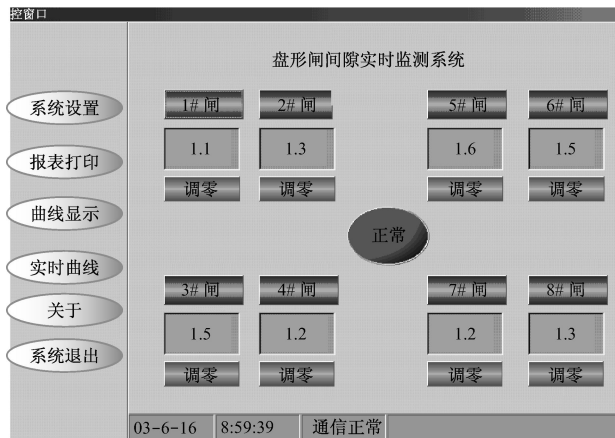
图 4 盘形闸间隙计算机实时监测系统主控界面
