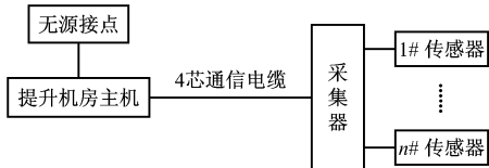
图 1 盘形闸间隙保护电气结构图
