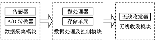
图 2 无线传感器节点结构示意图
