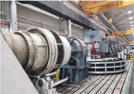
图 6 有载试验台现场
