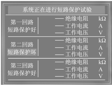
图 9 系统进行短路保护自检试验的显示界面
