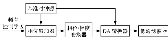
图 1 DDS 基本工作原理
