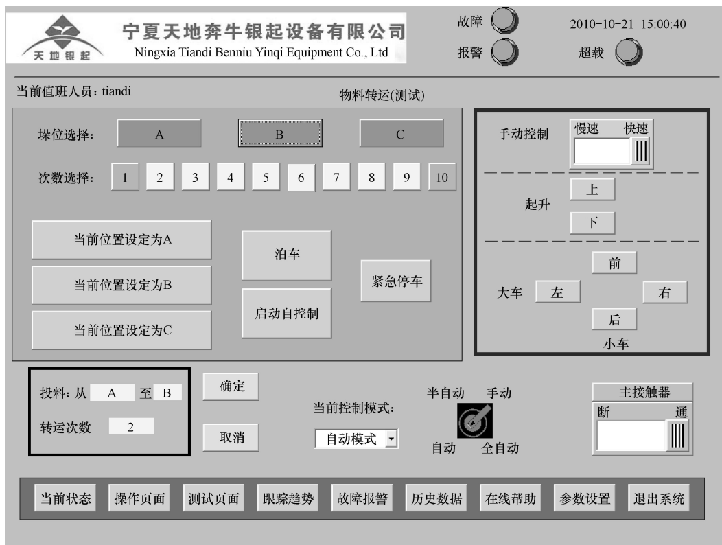
图 4 多台起重机组成的无人化垃圾仓储管理系统操作界面
