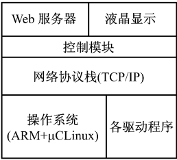
图 2 智能光纤收发器的软件平台框图
