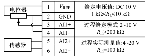
图 6 变频器 PID 控制的外部接线
