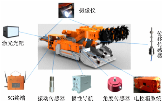
图 3 连续采煤机自动化系统硬件组成
