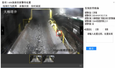
图 7 胶带机跑偏检测
