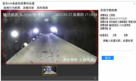
图 9 胶带输送机空载检测
