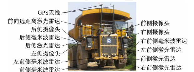
图 2 矿用自卸卡车车载传感器配置位置
