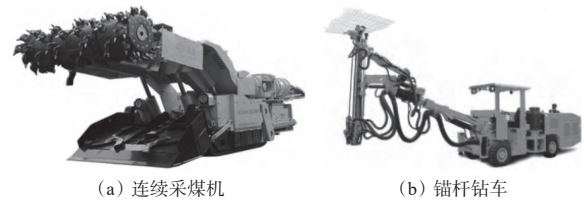
图2 连续采煤机掘进技术的掘进与支护设备
