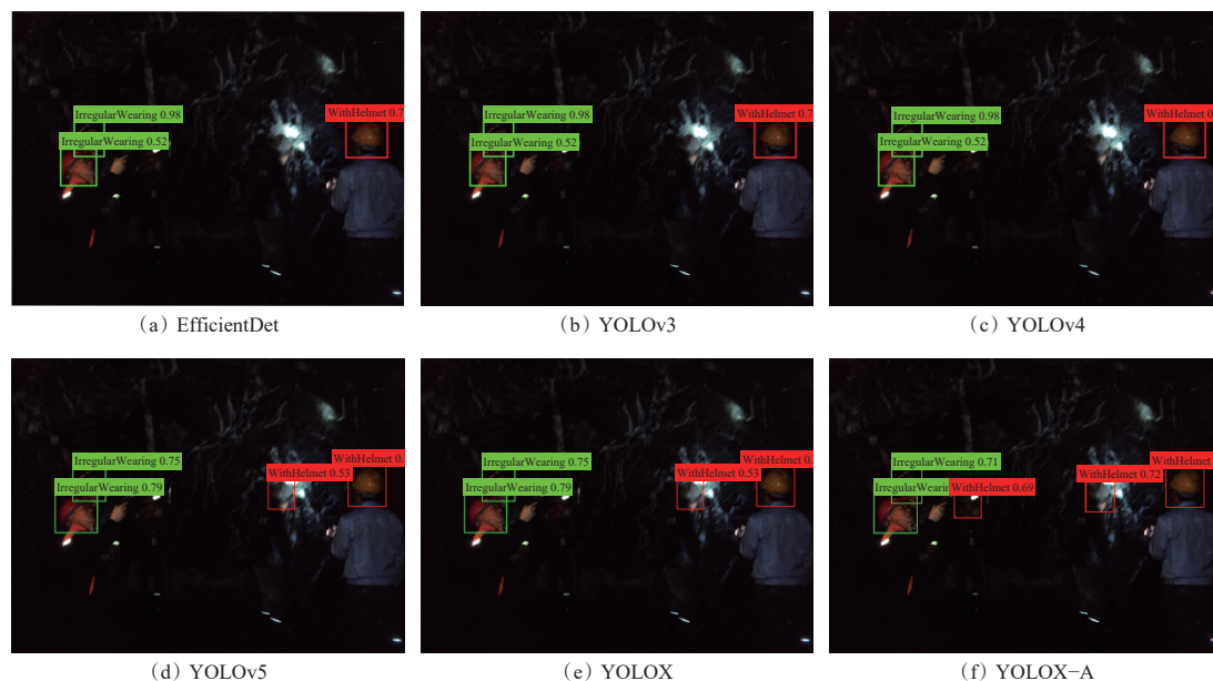
图9 不同目标检测模型对作业人员佩戴安全帽的检测结果
