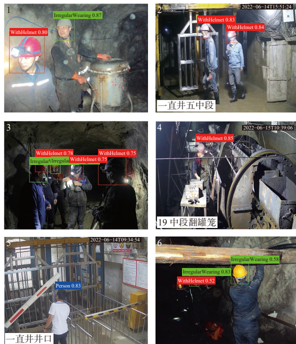
图 8 YOLOX-A 模型对作业人员佩戴安全帽识别结果
