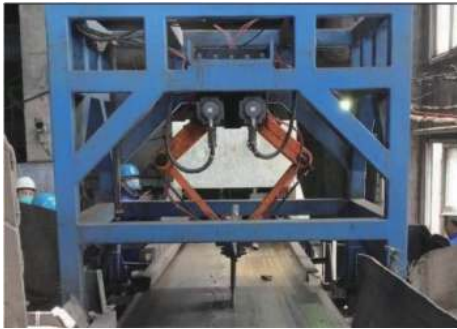
图 8 并联式选矸机器人应用现场
