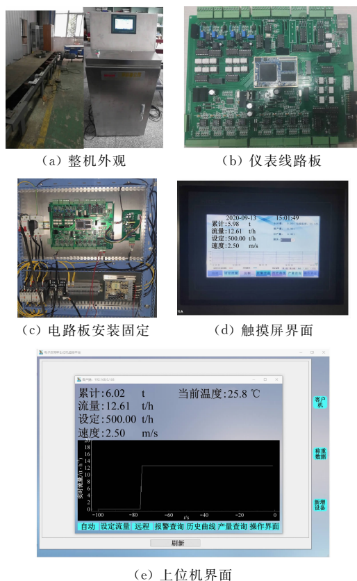
图7 现场安装与试验
