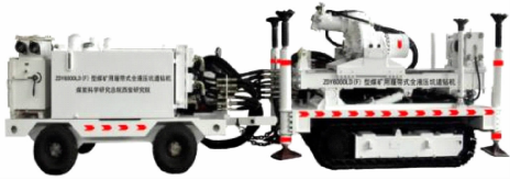
图 1 定向钻机实物
