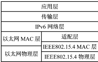
图 6 以太网 IP 协议与 6LowPAN 协议分层结构 Fig. 6 Hierarchical structure of Ethernet IP protocol and 6LowPAN protocol
