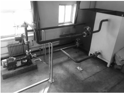
图 2 离心泵寿命加速试验平台
