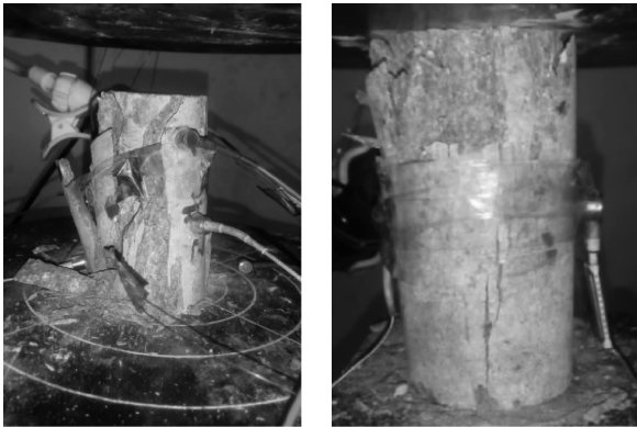
图2 破坏的砂岩实物
