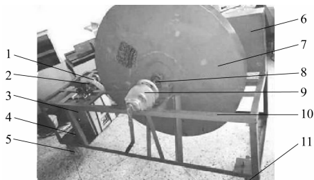
1—组合式卷筒扁平电缆;2—计数轴;3—数据采集系统; 4—探头保护板;5—固定脚轮;6—电气箱;7—卷线盘; 8—传动轴;9—绞盘;10—机架;11—带刹车活动脚轮
