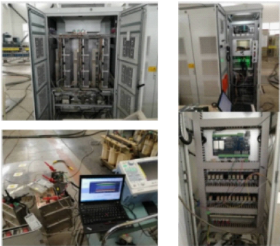
图3 逆变器电流信号采集实验平台
