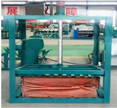
图 3 组合封堵气囊抗压物理试验平台
